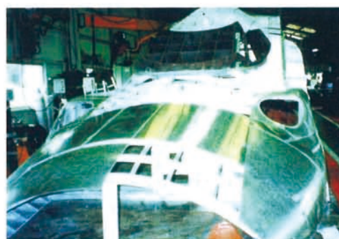
図12 骨組の例(格子状の部分)
