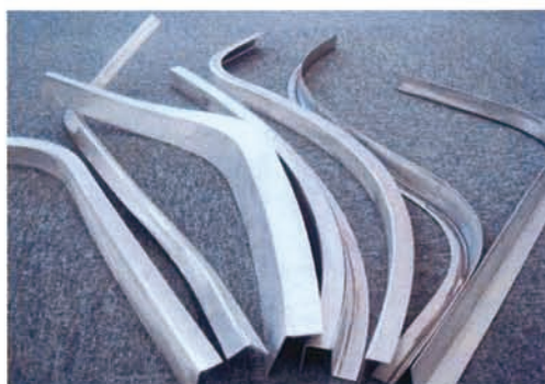
図9 窓枠カバー(三次元立体曲げ：端面が直角～鈍角への異形曲げ)
