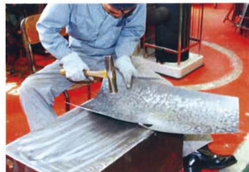
図2 打ち出し成形中の技能者
