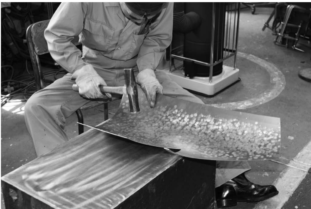
新幹線先頭構体のアルミニウム合金板をハンマーで叩く板金職人。 ハンマーは材質・大きさが様々なごく普通のものを職人たちが共用している。 写真提供 山下工業所
